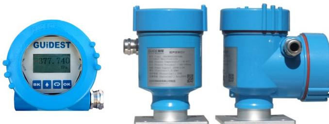
**SX-300A 防爆显示仪表**，是一种多功能显示仪表，它适用于各种工艺现场，可进行多种现场信号采集显示，便于工人巡检监控；可采集 4-20mA 模拟量、PT100 热电阻、热电偶等信号，并可参与控制、变送等简单信号处理；采用铝合金壳体，防护等级可达 IP65/68，防爆标志 ExiaIIBT6，适用于环境条件恶劣的工艺环境。
